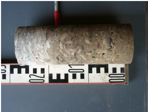
Das Öl ist fast 20 cm tief in den Beton eingedrungen (von rechts betrachtet)
